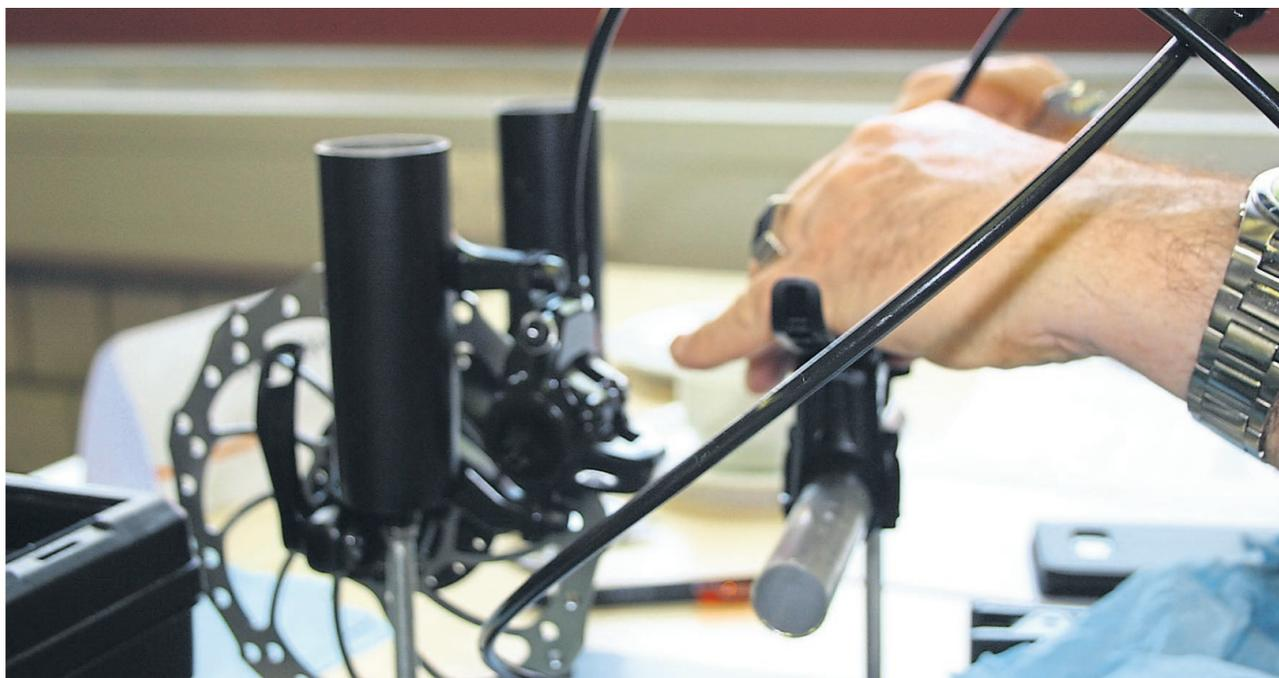
Entlüftung einer Magura-Scheibenbremsanlage.
