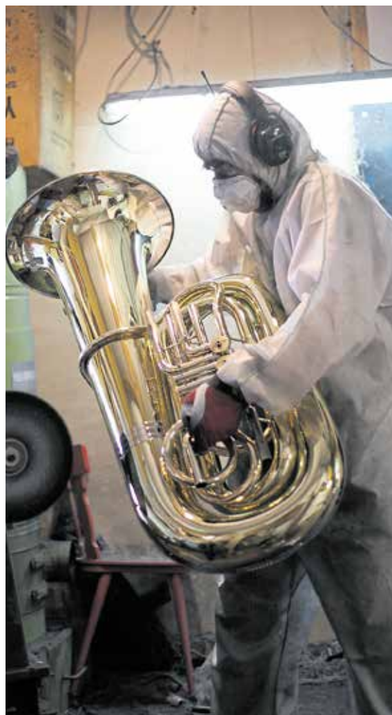
Metallblasinstrumentenmacher Andreas Klingspor gab Einblick in den Arbeitsschritt des Hochglanzpolierens.
